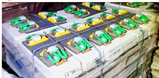
7 – rasm. Bozberg/STEDEF yo‘l konstruksiyasida foydalanilgan Pandrol Vipa DFC mahkamlagichli yangi bloklar. (Barselona, Ispaniya).
