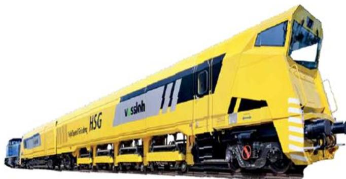
Рис. 1 Шлифовальный поезд HSG-2. [3].
