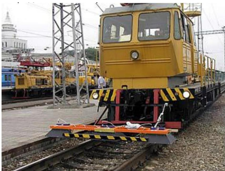
Рис. 1. Трехканальный георадарный комплекс с рупорными антенными блоками АБ-400Р
