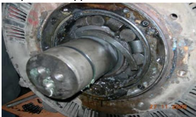
Рис 1.4. Заклинивание подшипников ТЭД
