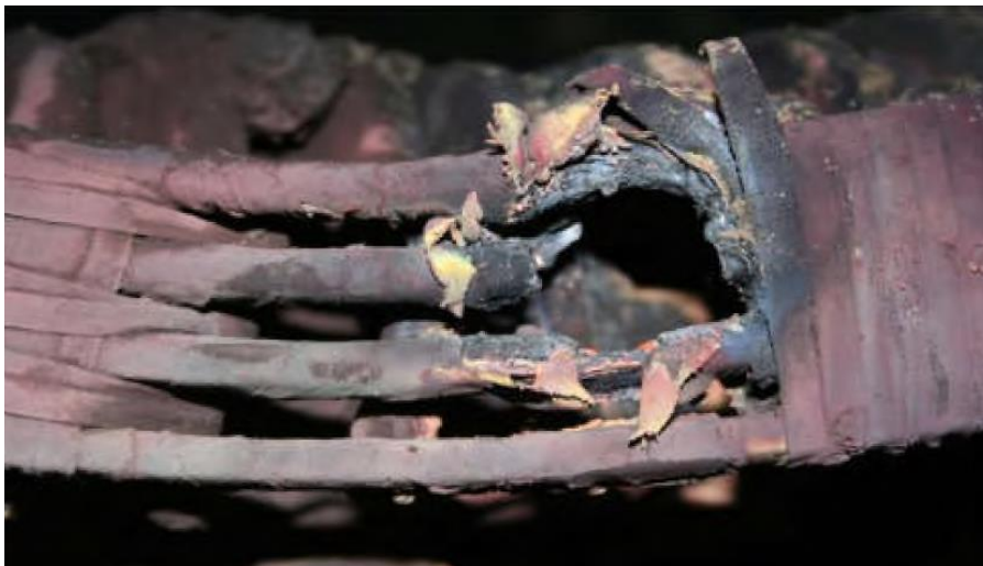
Рис 1.1. Повреждение обмоток статора ТЭД типа 1ТВ 2КФ2624
